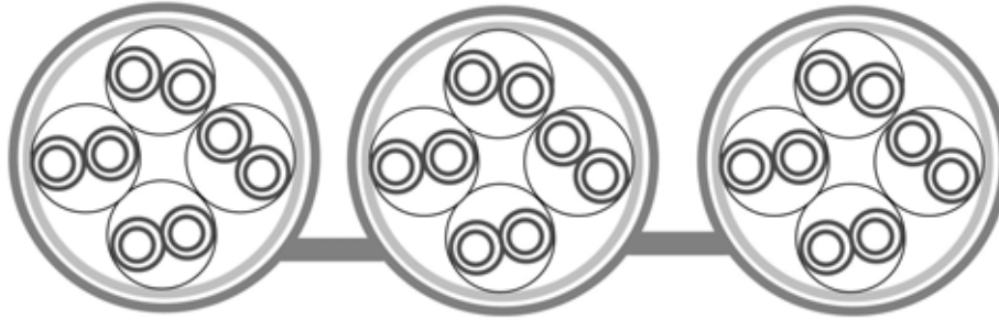
Abb.10-14: Darstellung des Aufbaus einer F / FTP-Triplex-Leitung zu einer Stegleitung geformt
