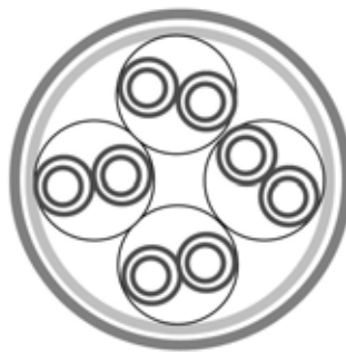
Abb. 10-11: Darstellung des Aufbaus einer F / FTP-Simplex-Leitung
