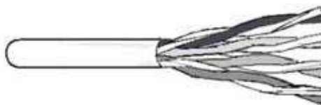
Abb. 10-2: Paarverseilungen innerhalb einer Leitung
