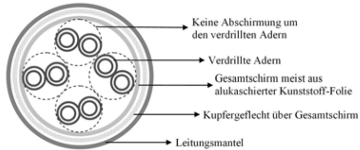
Abb. 10-7: Darstellung des Aufbaus einer SF / UTP-Leitung
