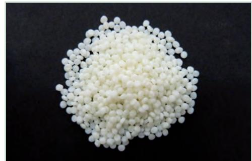
26. Das Granulat wird auf Extrusionsanlagen hergestellt. Dabei wird zwischen Heiß- und Kaltgranulierung unterschieden.
