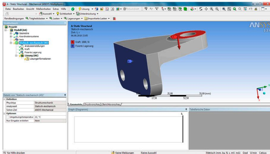
Im Strukturbaum sollte jetzt alles grün angehakt sein, bis auf Netz und Lösung, die mit einem gelben Blitz versehen sind, der symbolisiert, dass diese noch berechnet werden müssen. Sind darüber hinaus unvollständig definierte Randbedingungen (erkennbar an einem blauen Fragezeichen) definiert, löschen Sie diese (anklicken, rechte Maustaste). Mit **DATEI/PROJEKT SPEICHERN** wird die bisherige Definition der Berechnung gespeichert.
