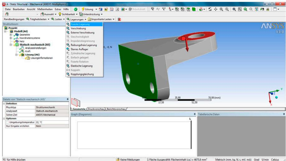
Nachdem im Strukturbaum lediglich die gerade definierte Lagerung markiert wird, wird auch nur diese im Grafikenfenster angezeigt. Um alle definierten Randbedingungen zu sehen, können mit der CTRL/STRG-Taste im Strukturbaum zusätzliche Randbedingungen oder mit einem Klick auf **STATISCH-STRUKTURMECHANISCH** der gesamte Lastfall markiert werden (siehe nachfolgende Abbildung).
