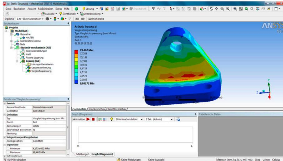
Das Spannungsmaximum erscheint nicht mit einer glatten Verteilung, sondern die Abgrenzung der verschiedenen Farben ist grob und gezackt. Dies deutet auf eine unzureichende Vernetzung für eine Spannungsbewertung hin. Genauere Spannungen können berechnet werden, indem in der Kerbe eine feinere Vernetzung definiert wird. Dazu stehen zwei Methoden zur Verfügung:
