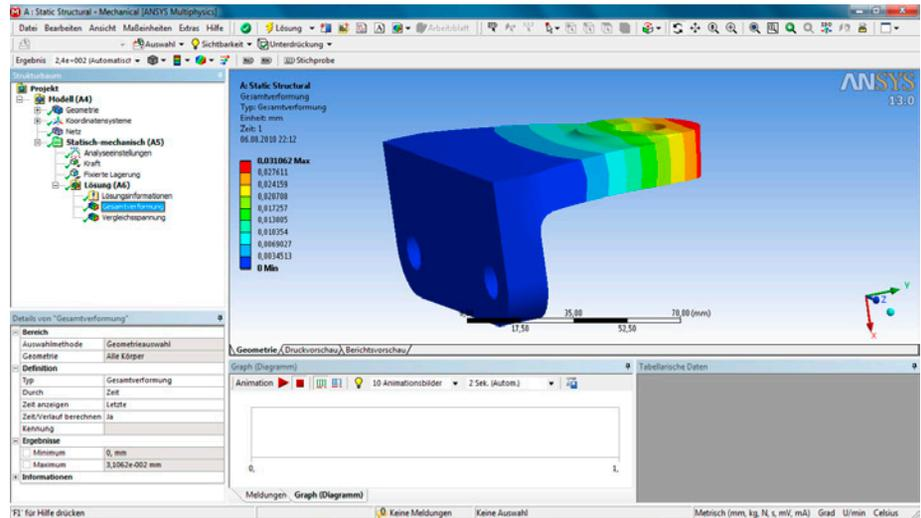
Der Winkel verformt sich in Kraftrichtung, die Größe der Verformung mit 0,03 mm scheint realistisch. Die Verteilung der Verformung wird durch abgestufte Farbbänder dargestellt, deren Grenzlinien (z. B. zwischen Blau und Hellblau) glatt und rund sind. Damit ist ein erster grober Anhaltswert auch bezüglich der Genauigkeit des verwendeten Netzes gegeben.
