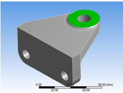
In der Statusleiste am unteren Rand des Mechanical-Applikationsfensters werden die Anzahl der selektierten Flächen und der Flächeninhalt angezeigt (eine Fläche ausgewählt; Flächeninhalt ca. = 992 mm<sup>2</sup>).
