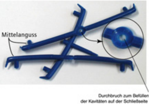
Bild 13.16: Teile eines Kaltkanalangusses für Tandemwerkzeuge [13.18, 13.19]
