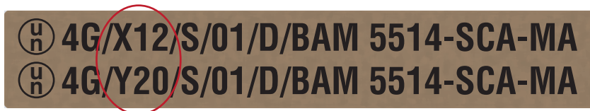
Abbildung 2b: Beispiele für die Kennzeichnung von Gefahrgutverpackungen – zulässig für Lithium-Metall-Batterien
