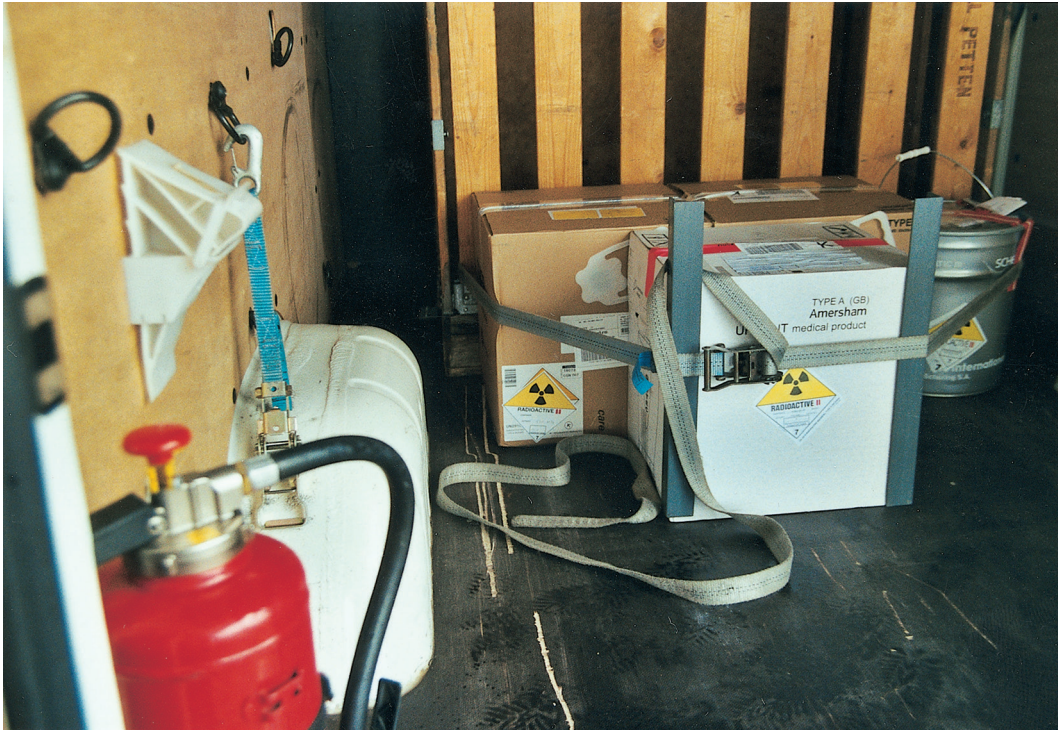
Ladungssicherung mittels Spanngurten bei leichten Versandstücken. Man beachte die Kantenschoner am vorderen Versandstück.
