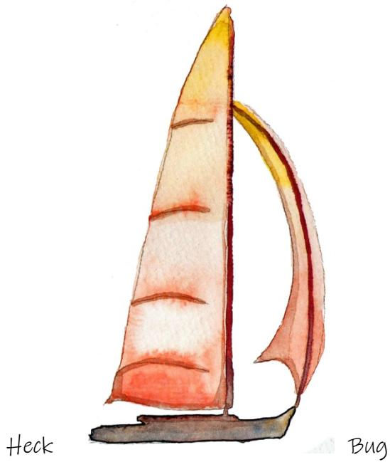
Der lange Holzbalken, der aus der Mitte des Rumpfes ragt, heißt Mast. Daran ist das Großsegel befestigt und wie der Name schon sagt, ist es das größere der beiden Segel. Das rechte, kleinere nennt man Fock oder Vorsegel.
