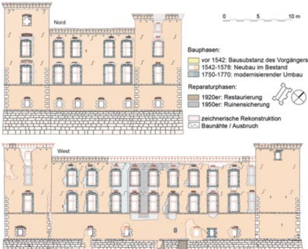
11. Siersdorf, baubegleitende Befund- und Baualterskartierung der Fassaden. Grundlage: maßstäbliche Fotobildpläne, 2013–2021.
