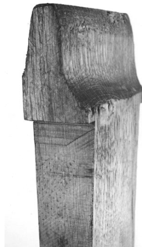
Bild 1/4 Verschlissener Holzzahn eines Göpelantriebes
