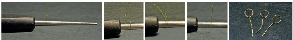
Der Draht wird um den Dorn gewickelt und verdrillt.
