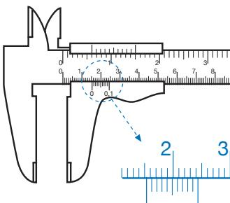
Man prüft, der wievielte Teilstrich der Noniusskala mit einem Teilstrich der Millimeterskala übereinstimmt. Wenn z.B. der dritte Teilstrich übereinstimmt, so beträgt die über den letzten vollen Millimeter hinausgehende Strecke 0,3 mm, denn für die über den letzten Millimeter hinausgehende Strecke  $x$  gilt:
