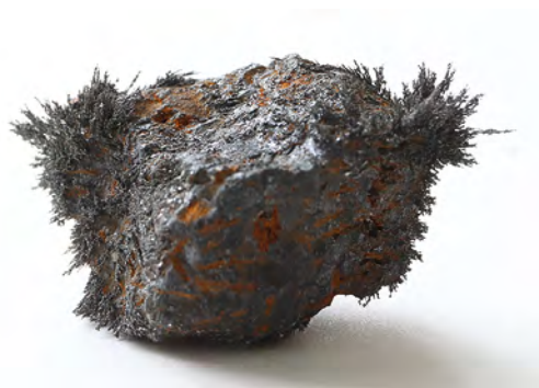
Abb. 2 Magneteisenstein zieht Eisenfeilspäne an.
