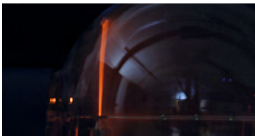
Abb. 2 Fadenstrahl (ohne Magnetfeld)
