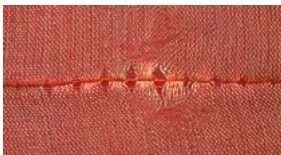
2 Gewebe mit geringer Nahtschiebefestigkeit
