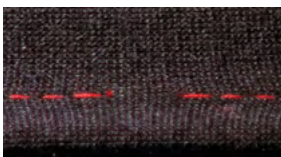
3 Gerissene Naht nach übermäßiger Dehnbeanspruchung
