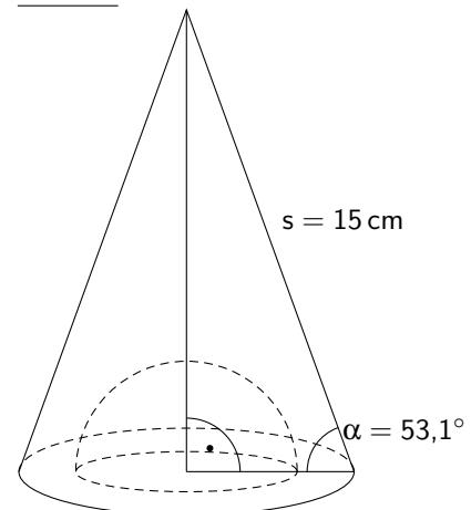
Das Volumen des Werkstücks entspricht nun dem Volumen  $V_K$  des Kegels, abzüglich des Volumens  $V_H$  der Halbkugel. Mit den ermittelten Längen können diese Volumina bestimmt werden:
