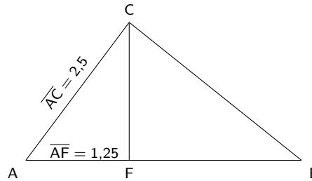
$$\begin{aligned}\overline{AC}^2 &= \overline{AF} \cdot \overline{AB} & | : \overline{AF} \\ \iff \overline{AB} &= \frac{2,5^2}{1,25} \\ \iff \overline{AB} &= 5\end{aligned}$$
