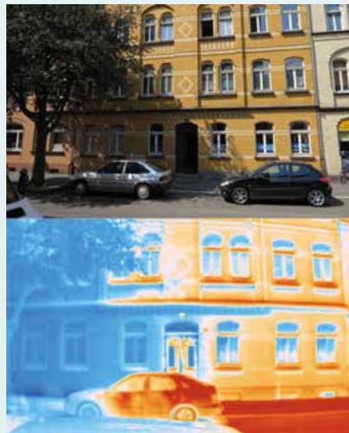
Abb.10: Foto und Themografie-Aufnahme eines Wohngebäudes im städtischen Straßenraum. Die Themografie verdeutlicht, dass der Schatten des Baumes die Fassade nachhaltig kühlt.
