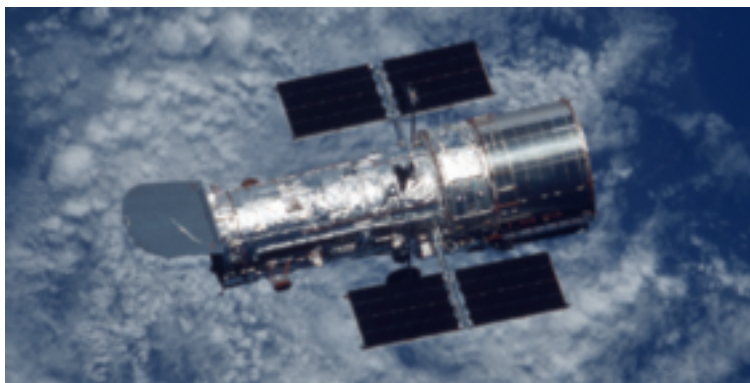
Abb. 3: Im Jahr 1990 wurde das Hubble Space Telescope (HST) in eine erdnahe Umlaufbahn außerhalb der Erdatmosphäre gebracht. Seine volle Leistung erreichte es jedoch erst 1993, nachdem man in einer Reparaturmission die Abbildungsfehler des Hauptspiegels mit einer Korrekturlinse beseitigt hatte. Seitdem liefert das HST immer wieder spektakuläre Bilder aus den Tiefen des Kosmos.
