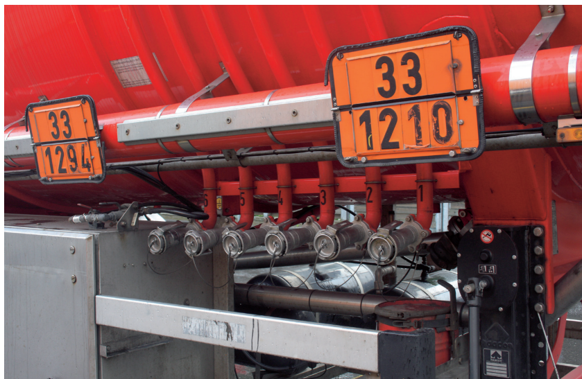
Mehrprodukten Chemietankfahrzeug mit Einzelauslässen, d.h., jede Kammer hat eine eigene Abgabelitung oder ein eigenes Abgabesystem.
