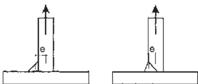
b) Zugkraft erzeugt Zug in der Schweißnahtwurzel
