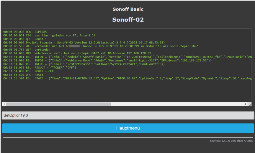
Abbildung 15.21 Der Befehl »SetOption19 0« auf dem Tasmota-Gerät
