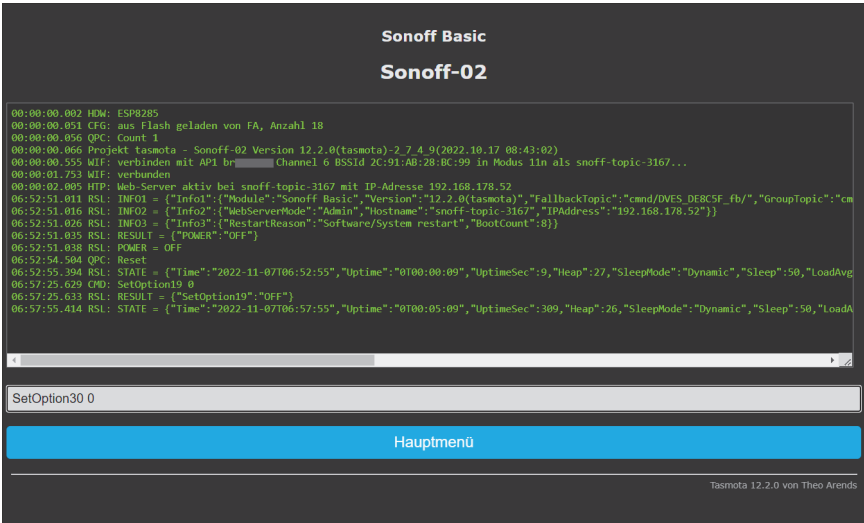
Abbildung 15.22 Tasmota-Gerät mit dem Befehl »SetOption30 0«
