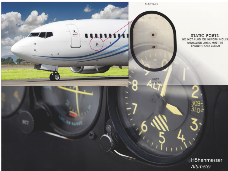
Abb. 1.3 Messstellen für den statischen Druck (engl.: Static Port) eines Passagierflugzeuges des Typs Boeing 737. Bild oben links: © Stefano Garau – stock.adobe.com (#71338630), Bild oben rechts: © Stephen – stock.adobe.com (#164883125), Bild unten: © h368k742 – stock.adobe.com (#84083976)
