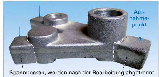
Bild 2: Umlenkhebel mit angegossenem Spannnocken
