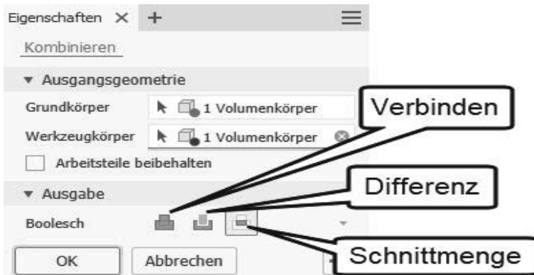
Abb. 1.21: Boolesche Operationen VEREINIGUNG, DIFFERENZ und SCHNITTMENGE
