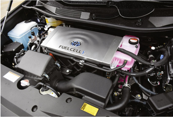
Bild 1.4 Bauteile aus Polyamiden (PA), Polypropylen (PP) und Polyethylen (PE) sowie Elastomeren im Motorraum eines Toyota Mirai mit Wasserstoffbrennstoffzelle (iStock.com/Tramino)
