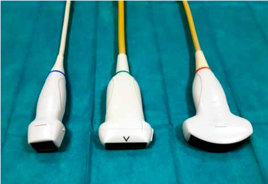
ABB. 5 ► Von links nach rechts: Sektorschallkopf, Linearschallkopf, Konvexschallkopf
