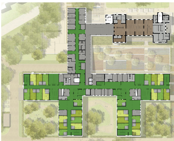
Abb. 2 Grundriss der Eingangsebene mit Darstellung des farbigen Bodenbelags © ajsh sander.hofrichter architekten
