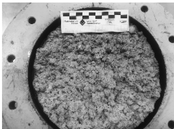
Bild 17. Spritzbetonoberfläche des Versuchsaufbaus mit 8 mm Rundkorn
