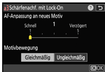
Abb. 1.30 Mit der Individualfunktion »a3 Schärfenachf. mit Lock-On« geben Sie vor, wie schnell oder träge der Autofokus reagieren soll, wenn er ein Motiv nicht mehr erfasst.
