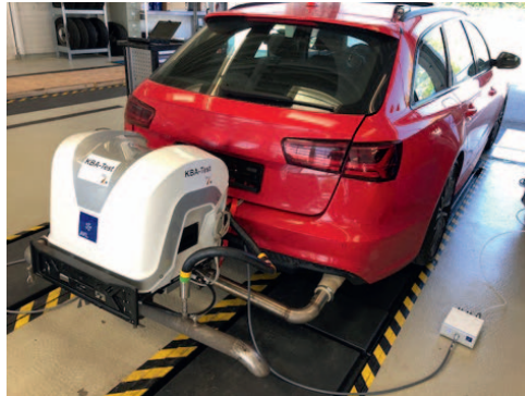
Bild 1.10: Abgastest im Fahrbetrieb [KBA 22]
