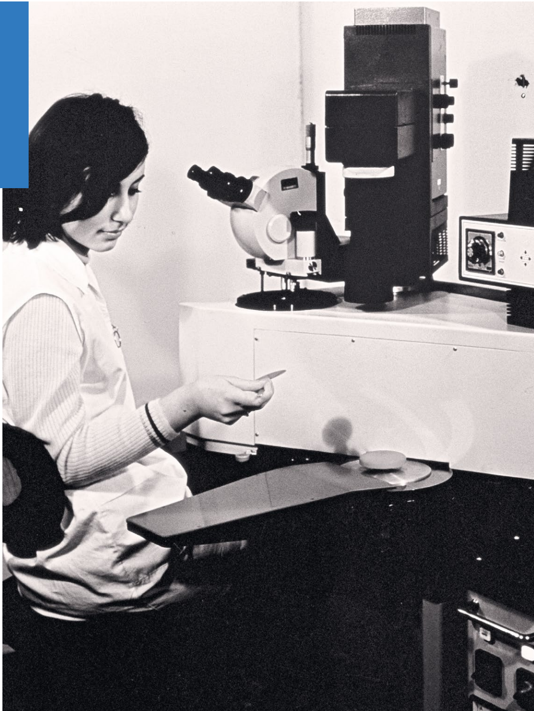
Für diese Maschine zur 1:1-Projektionsmaskierung (Typ 689, Ende der 1960er Jahre) nutzte AEG-Telefunken Objektive von ZEISS, konkret das S-Planar 2/200 mit einer numerischen Apertur von 0,125 (Typnummer 10 77 18 für die Wellenlänge 436 Nanometer beziehungsweise 10 77 19 für die Wellenlänge 405 Nanometer). Vertrieben wurden die Geräte durch den US-amerikanischen Marktführer Kulicke & Soffa.
