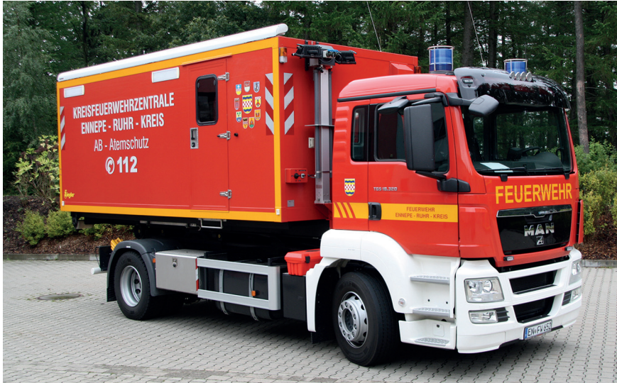
Abbildung 30: Wechseladerfahrzeug WLF (Quelle: Manuel Siegmon, Frönden-berg)
