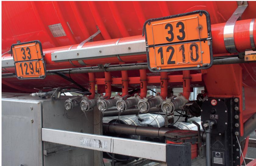
Mehrprodukten Chemietankfahrzeug mit Einzelauslässen, d.h., jede Kammer hat eine eigene Abgabeeleitung oder ein eigenes Abgabesystem.
