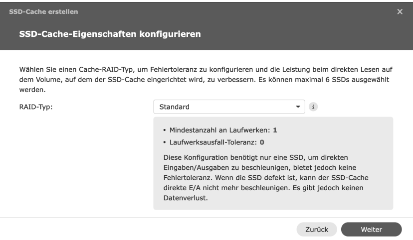
Abbildung 9.10 Auswahl des RAID-Typs für den SSD-Cache
