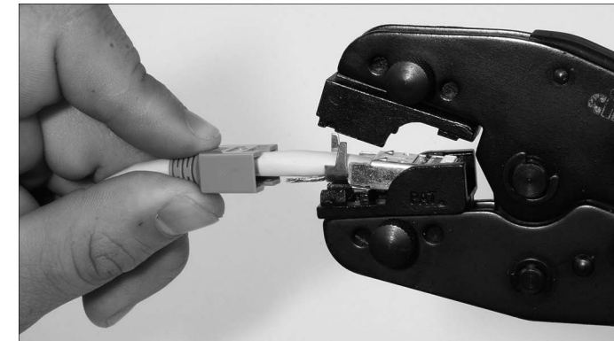
Abbildung 2.23 Einführen des RJ45-Steckers in das Crimpwerkzeug
