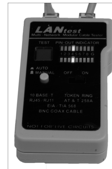
Abbildung 2.26 Prüfung der Patchkabel
