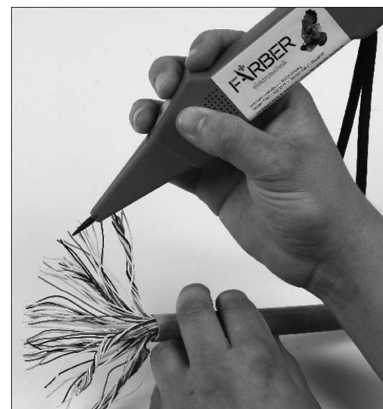
Abbildung 2.30 Arbeiten mit dem Tastkopf an einem Adernbündel
