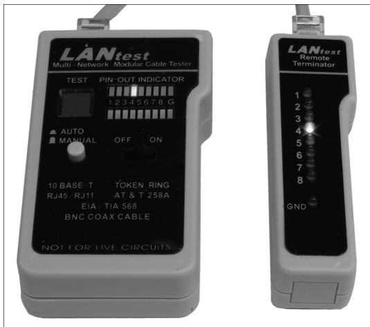
Abbildung 2.27 Streckenprüfung mit Satellit
