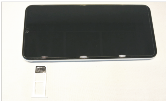
Abbildung 1.10: Schieben Sie das Fach wieder in das Gerät.
