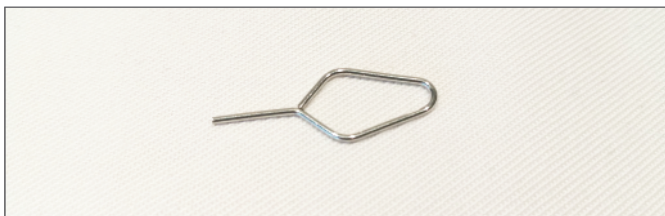
Abbildung 1.5: Die SIM-Karten-Nadel zur Öffnung der Schublade.
