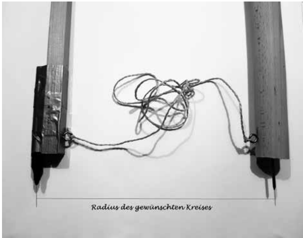
Abb. 1 (links): Selbstgefertigter Zirkel „entspannt“
