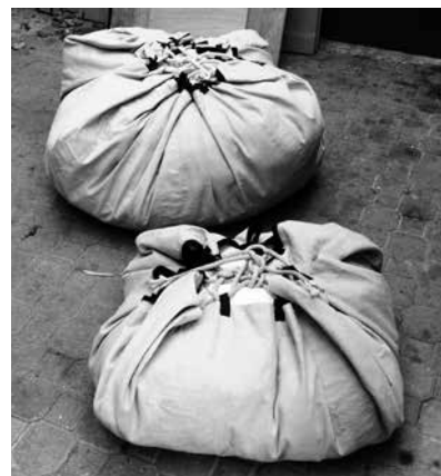
Abb. 3: Selbstgefertigte Bruchensäcke aus fester Zeltplane, zugebunden mit einem Seil, das durch Schlaufen geführt ist.
