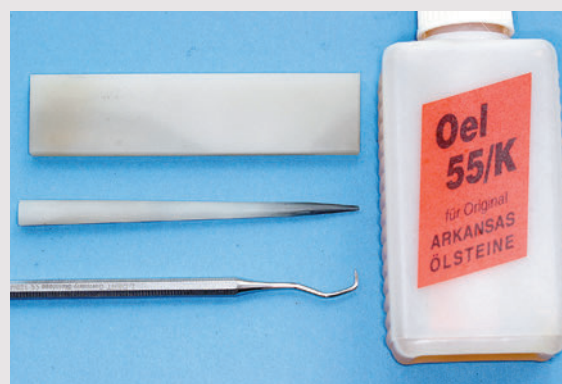
Abb. 1.15 Scaler, Öl zum Schleifen, flacher und konischer Arkansas Schleif-Stein
