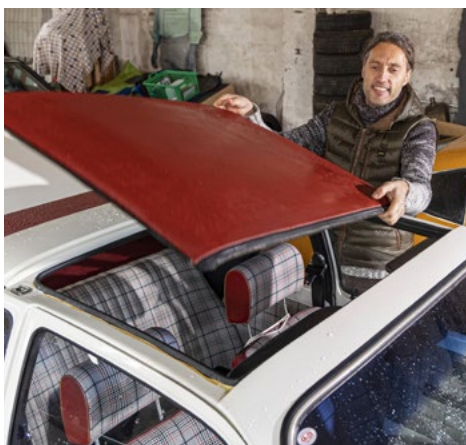
Geniale Lösung beim rund 1300-mal gebauten Kadett Aero: die Verriegelung des Dachteils mit vier Hebeln. Es findet Platz im Kofferraum
