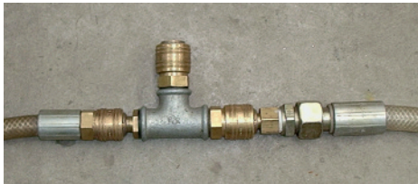
Bild 1-4 Abzweigung von der Luftzuführungsleitung in die einzelnen Schmierstationen (Quelle: Herrenknecht AG)
