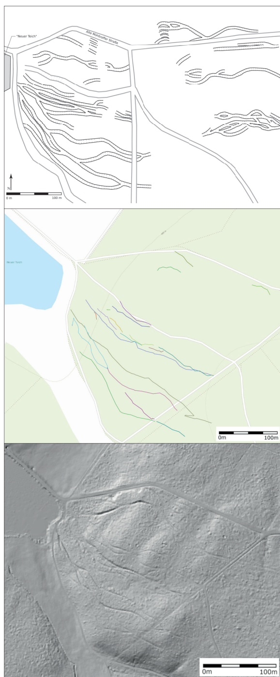
Abb. 1: Hohlwegbündel östlich von Oberböhmendorf: a) Skizze, b) Darstellung der GPS-Daten, c) DGM-Abbild.
