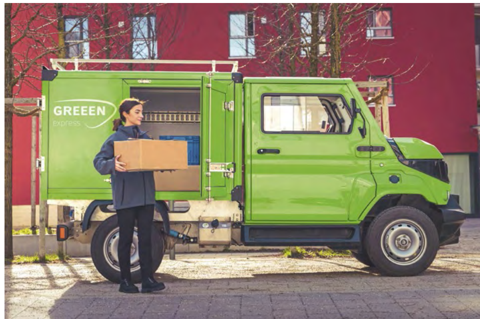
Evum A-Car – ein Kleintransporter mit elektrischem Allradantrieb
