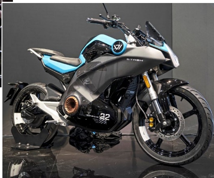
VMOTO: In der Leichtkraftrad-Klasse spielt das neue Elektro-Bike STASH mit Nabenantrieb im Hinterrad. Marktstart: 2022
