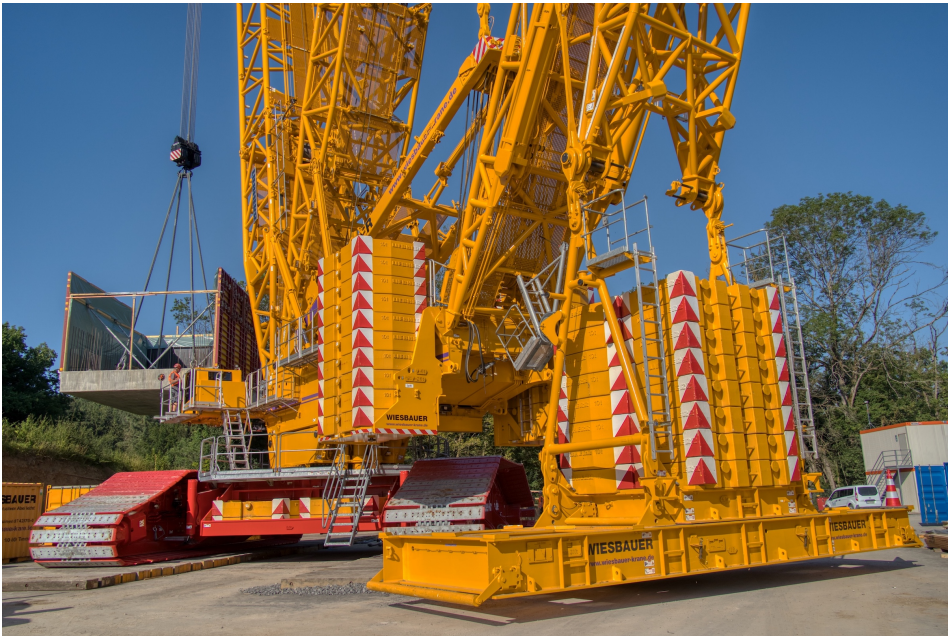
Bild 1.10 Ein Liebherr LR 11000 beim Einhub eines 200 Tonnen schweren Betonfundaments auf einer Bahnbaustelle bei Affalterbach 2020. Durch Gegenausleger und circa 300 Tonnen Gegengewicht kann der Ausleger diese Last auf bis zu 40 Meter Radius transportieren, ein Lastmoment, das mit einem Mobilkran undenkbar wäre. Man erkennt auch gut den Nachteil dieser Krankategorie: im Gegensatz zu Kranen mit Rädern sind Raupenkrane nicht sehr mobil; ein LR 11000 braucht je nach Konfiguration 40 bis 60 Schwertransporte und eine Woche Zeit zum Aufbau.
