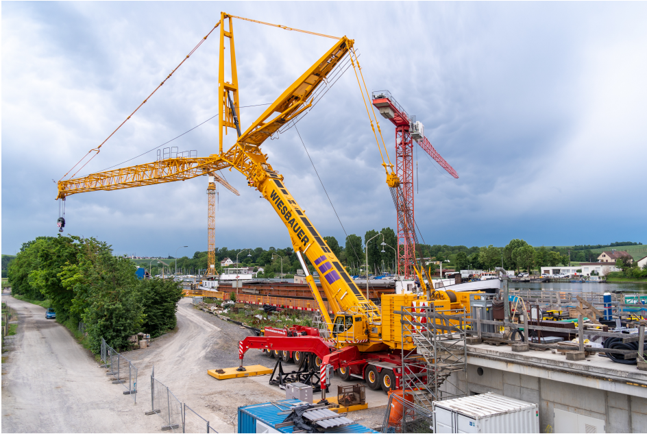
Bild 1.2 Ein LTM 1750 mit angebaute Gitterausleger (in diesem Fall einer sogenannten Wippe) zur Verlängerung der Reichweite des Krans. Natürlich ist die maximal mögliche Last bei Verwendung von solchen Verlängerungen erheblich geringer als ohne.
