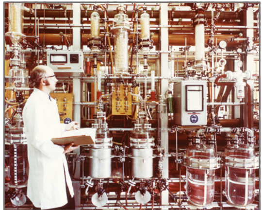
Bild 2: Optimierung der Reaktionsbedingungen in der halbertechnischen Anlage
