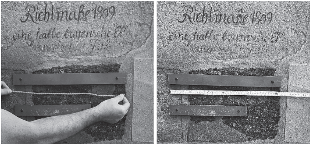
Abbildung 1.2: Zwei verschiedenen Messmethoden zur Längenmessung der bayrischen Elle am Schwabacher Rathaus: links die »Seil-Messmethode«, rechts die »Gliedermaßstab-Messmethode«
