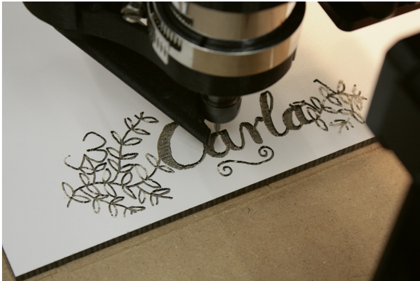
Bild 1.9 Auch das Gravieren gescannter Zeichnungen bringen wir der Fräse bei.
