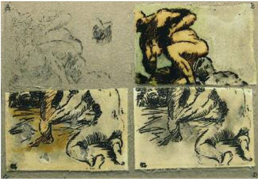
3 Vorversuche: Vorderseite der Glasplatte, frischer Druck (o. l.), kein Einweichen (o. r.), einstündiges (u. l.) und zwölfstündiges Einweichen (u. r.), Untergrund grau
