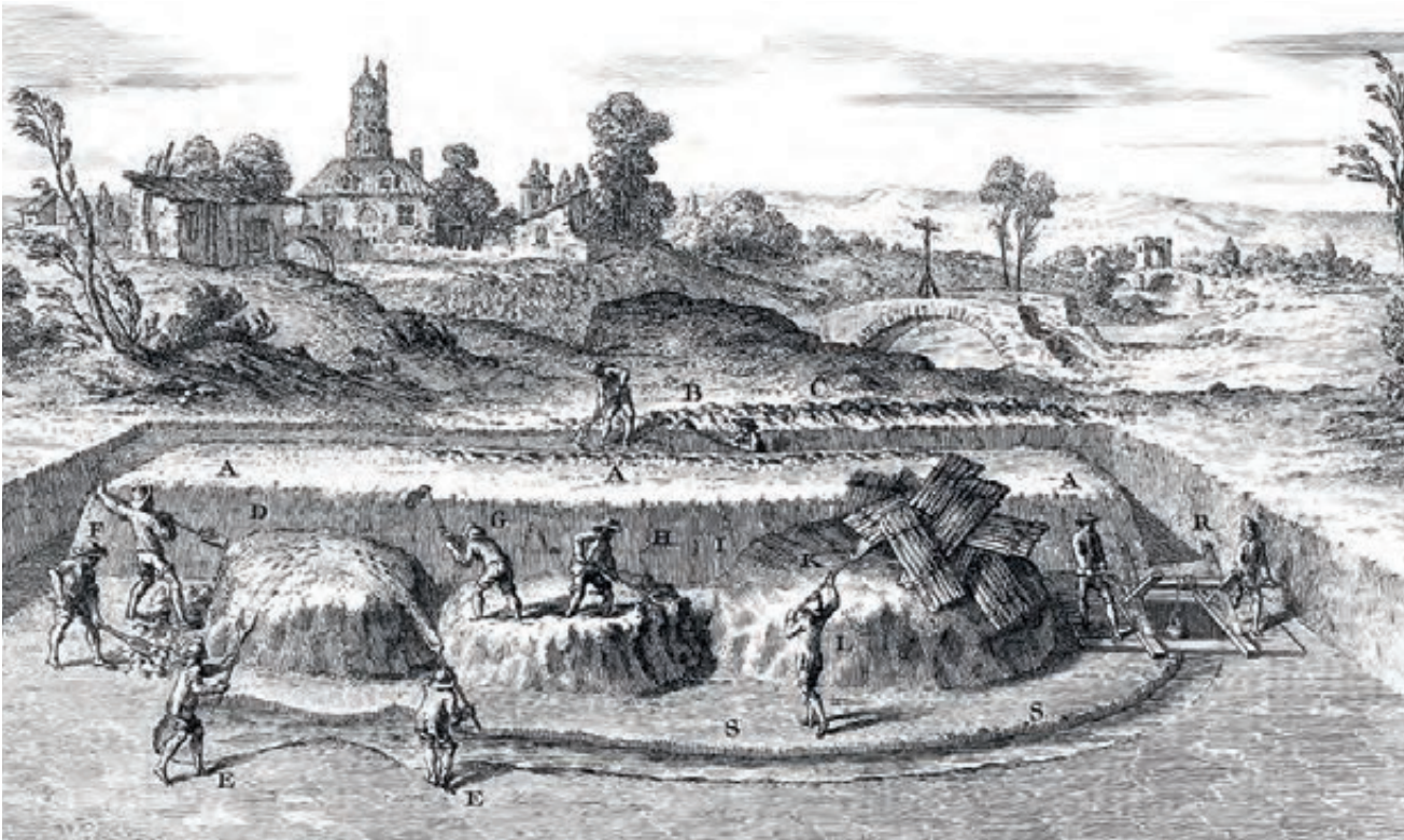
264 Manueller Tonabbau für eine kleine Feldziegelei in einer Darstellung aus dem 18. Jahrhundert.
