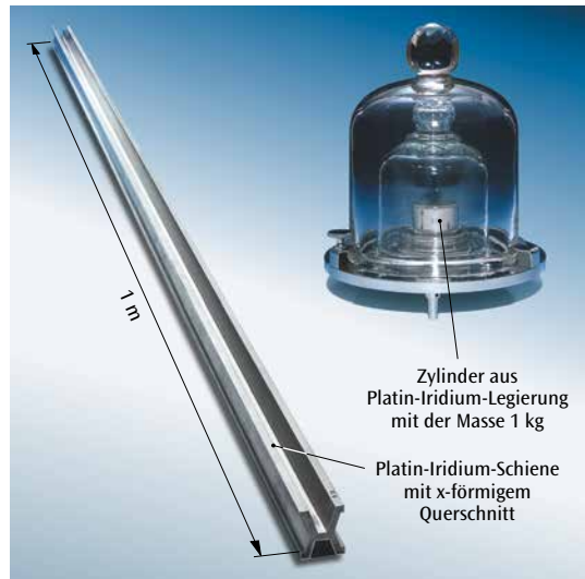
Bild 1: Kopien des Urmeters und des Urkilogramms
