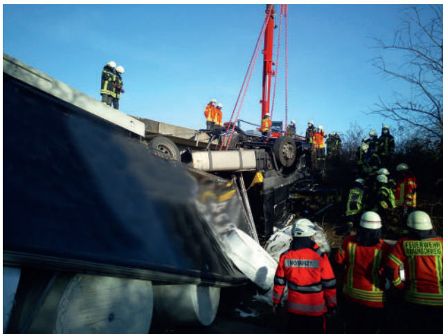
Bild 1: Einsatz eines Kranfahrzeuges zur Verhinderung des weiteren Kippens/Abrutschens (Foto: Rainer Madsack)
