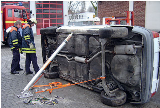
Bild 2: Stabilisierung mit einem Stützensystem (Foto: Jan Südmersen)
