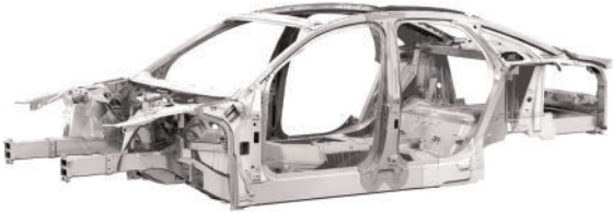
Bild 5: Selbsttragende Karosserie (Foto: ingeneurkurse.de)
