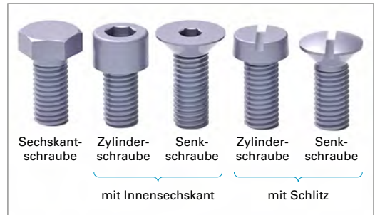
Bild 1: Kopfformen von Schrauben
